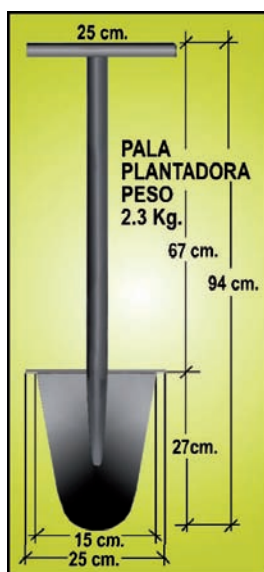
Figura N° 15. Pala Plantadora Utilizada Comúnmente en Plantaciones Forestales
